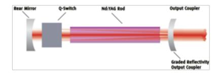
输出耦合镜为一个反射率呈高斯分布的梯度反射镜。其同样拥有较高的能量提取效率(80%),但近场光斑平滑均匀性一般,带有比较强的衍射环。调节泵浦灯电压和重复频率对光束特性影响比较大,使用中不建议调节。其最明显的优势是聚焦能力强,光束质量好,光束衍射倍率因子 M² 为 2 左右,发散角小。LIBS 领域广泛使用此腔形。
