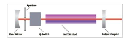
是在传统稳腔基础上添加一个孔径光阑,让基模辐射场振荡,过滤高阶模。除极差的能量提取效率(10%)以外,拥有传统稳腔所有优点。一个最明显的优点是光束质量好,光束衍射倍率因子 M²约1.2,发散角小。光束接近衍射极限光束。无论近远场,高斯拟合度大于95%。
